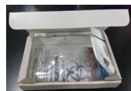
二次容器を三次容器で梱包した様子 （三次容器の蓋はテープ等を用いて開かないようにする）
